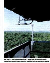
ANTENA Loka dan sensor suhu dipasang di semua lokasi mengumpul data pada gambut melalui IoT secara jangka panjang.
